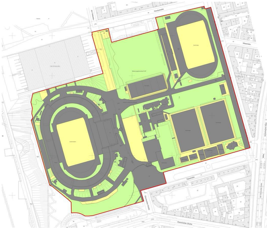
Abbildung 8: Flächenversiegelung im Plangebiet im Bestand
